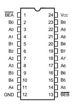
SOIC/ QSOP/ TSSOP TOP VIEW
